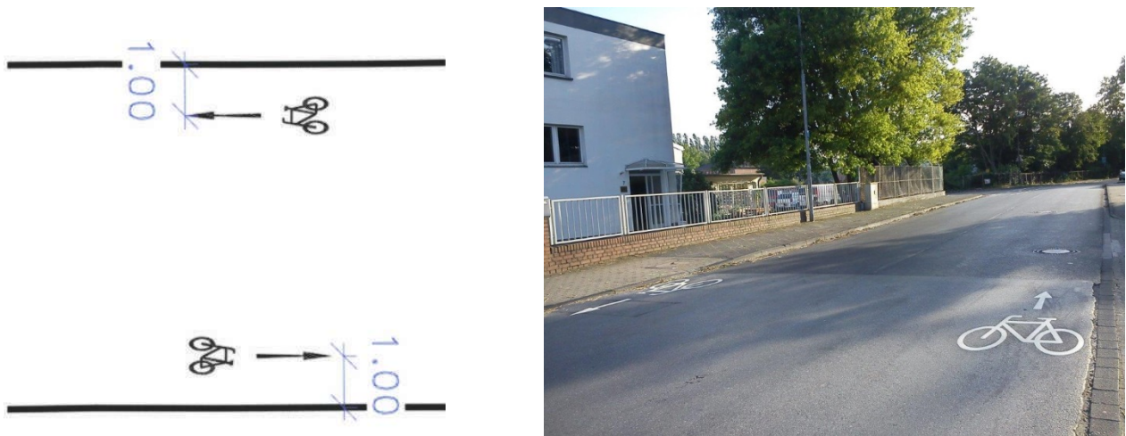
Abbildung 35: Fahrradpiktogramme als optische Radverkehrsführung (Prinzipiskizzen)
