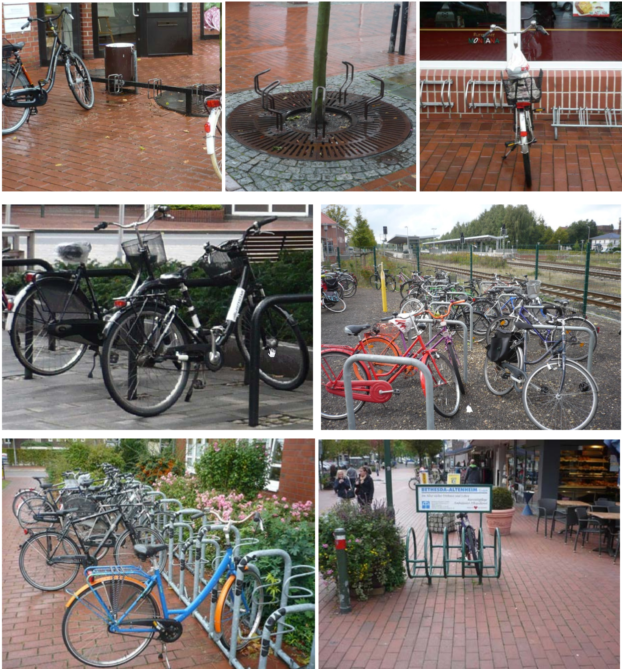
Oben: Vorderradhalter – nicht geeignet; Mitte: Anlehnbügel – gut geeignet, unten links: Gabelhalter Orion Beta – gut geeignet; unten rechts: sonstige Fahrradständer; Quelle: eigene Aufnahmen
