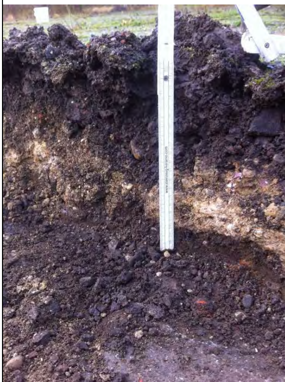
Nahaufnahme der Schichten und der Betonplatte
