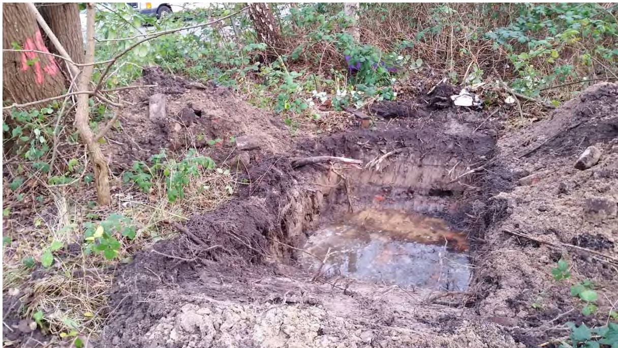
Gesamtansicht des Schurfes
