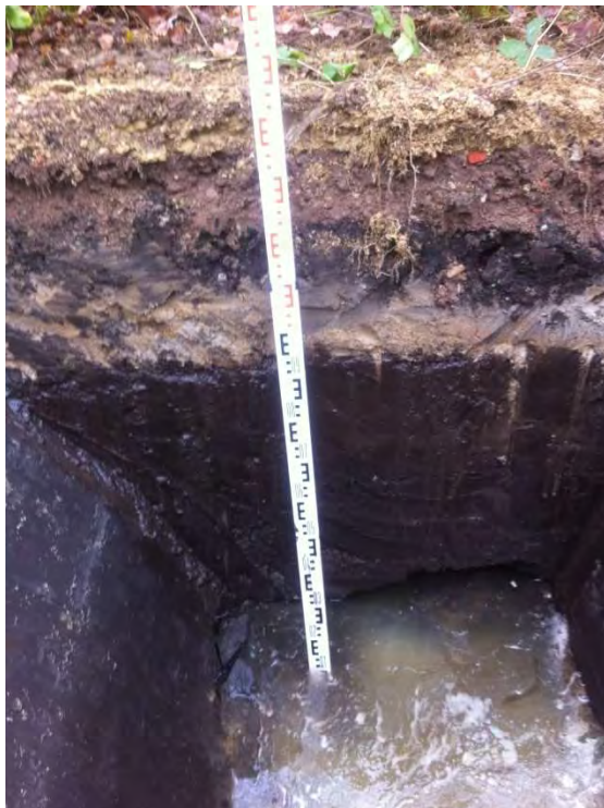
Schichtenfolge des Schurfes bis zur Wasseroberfläche
