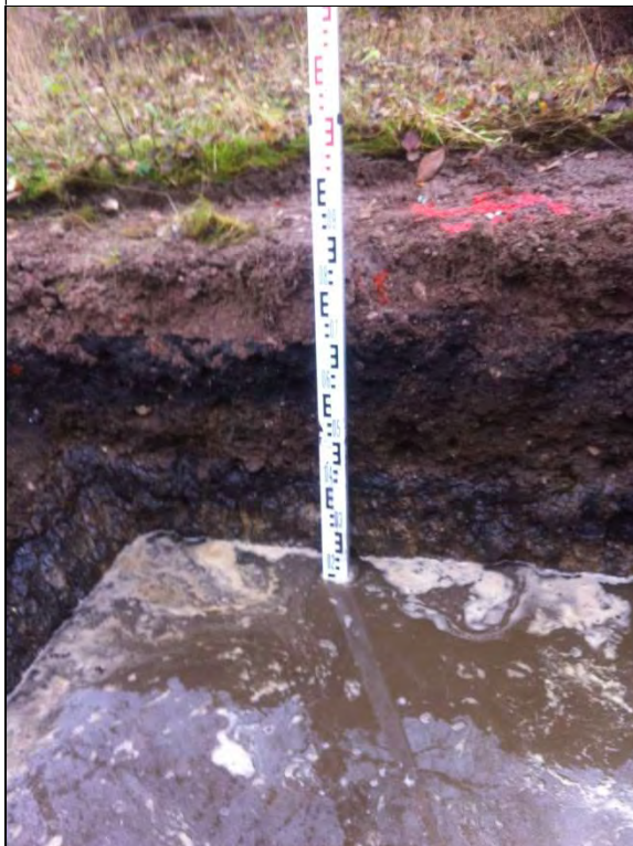
Schichtenfolge des Schurfes bis zur Wasseroberfläche
