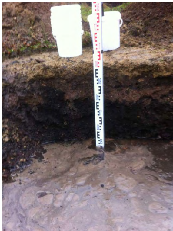
Schichtenfolge des Schurfes bis zur Wasseroberfläche
