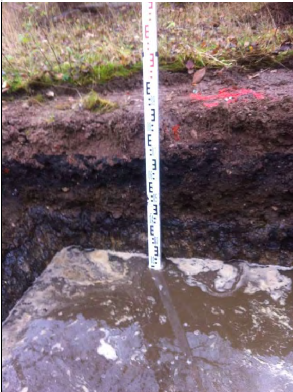
Schichtenfolge des Schurfes bis zur Wasseroberfläche
