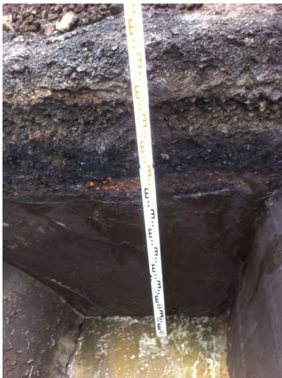
Schichtenfolge des Schurfes bis zur Wasseroberfläche
