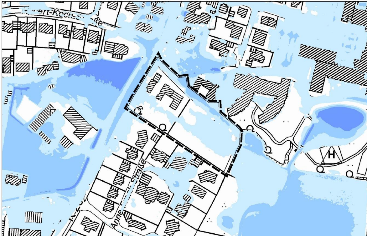
Abbildung 4: Wasserstände im extremen Starkregenereignis Darstellung extremes Starkregenereignis: Bundesamt für Kartographie und Geodäsie (2021) https://www.klimaanpassung-karte.nrw.de/ (zugegriffen am 07.12.2022) Datengrundlage Geländehöhen: DGM 1 (Digitales Geländemodell NRW, Stand 2019)
